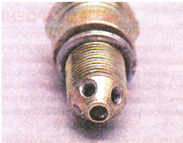
Рисунок 49 – Устройство плазменно-форкамерной свечи зажигания
