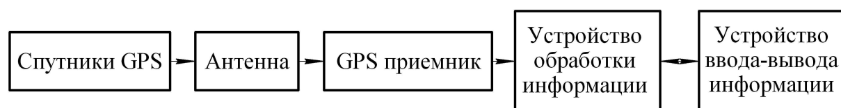
Рисунок 77 – Структурная схема автомобильной навигационной системы
